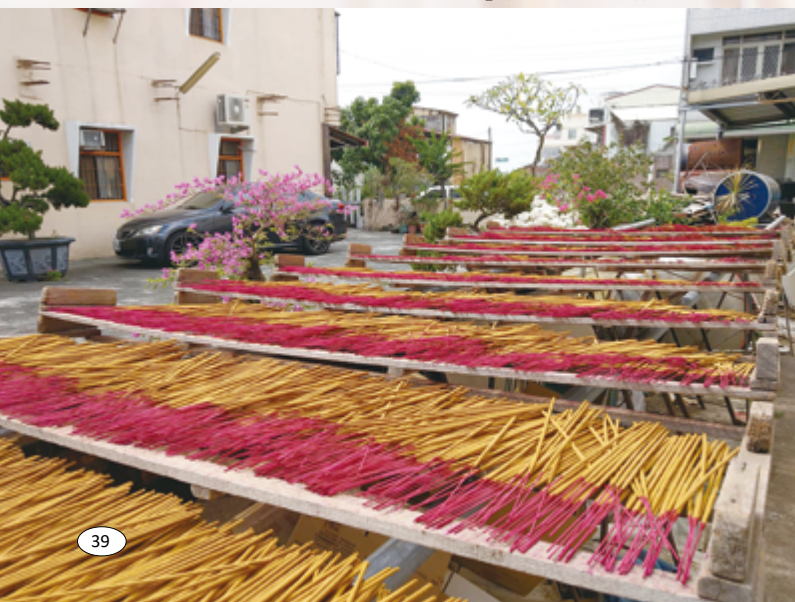
▲ 機器製香（左）與手工製香（右）可看出表面光滑度、燃燒速度、香灰長度與香腳收尾的差別
