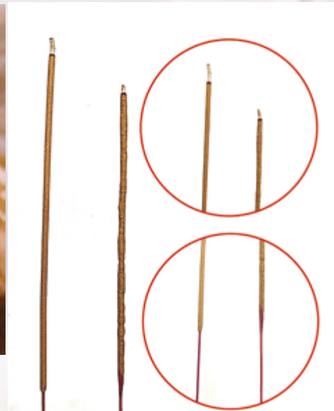
▲ 機器製香（左）與手工製香（右）可看出表面光滑度、燃燒速度、香灰長度與香腳收尾的差別
