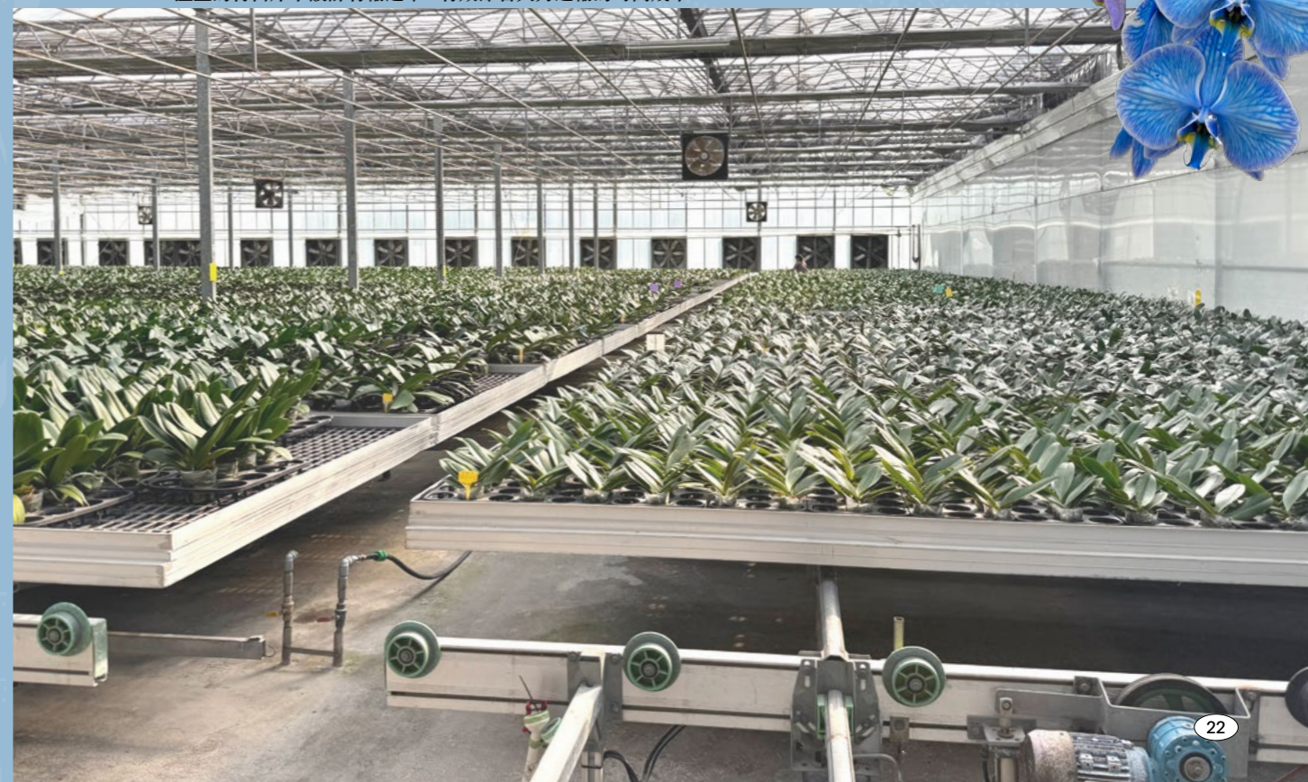
▼ 溫室的育苗床下設計有輸送帶，有效節省人力運輸的時間成本
