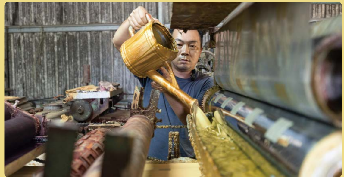
▲ 將調合後的金漆倒入金紙印製機
